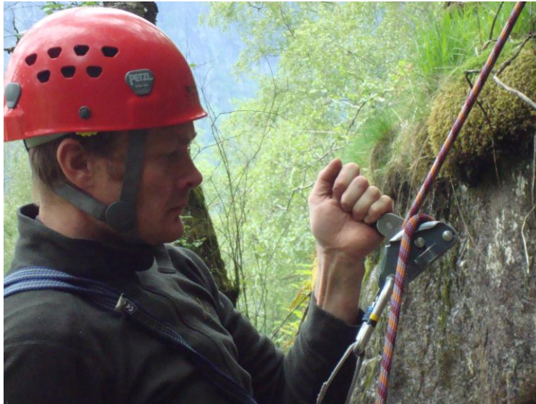
Figur 6. Bruk av GriGri. Det er viktig å lesa brukarmanualen som følgjer med grundig!
