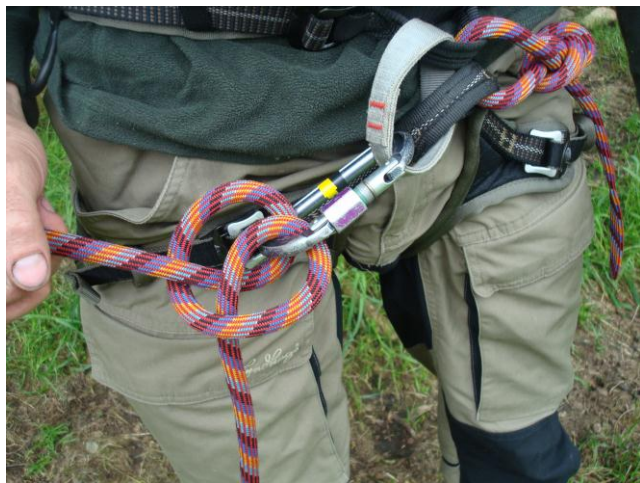
Fig. 3. Dobbelt halvstikk. Brukast for å binda seg inn i den andre forankringa på standplass. Knuten er lett å regulera.
