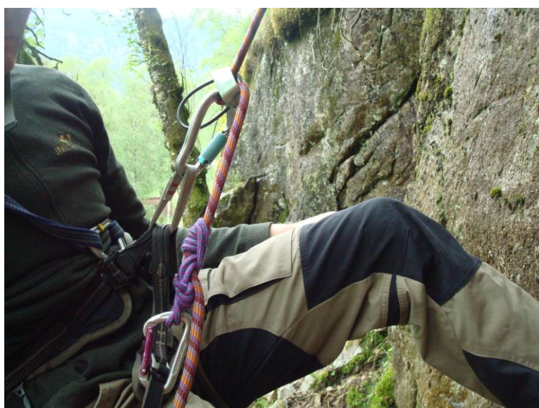
Figur 5. Rappell med taubrems og fransk prusik kobla til lårløkkja.
